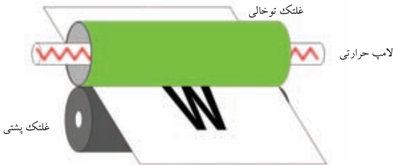
شکل ۱۴-۶ سیستم ذوب تونر Fuser و لامپ حرارتی که تولید گرما می کند
