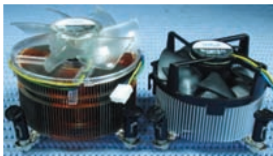
شکل ۴۳-۳ نمونه‌ای از سیستم خنک کننده‌ی پردازنده‌های core i7
