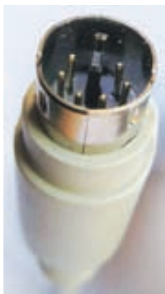
شکل ۲۲-۶ سمت راست، رابط USB و سمت چپ، رابط DIN شش پین یا PS/2
