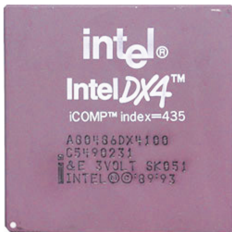
شکل ۲۵-۳ پردازنده ی ۴۸۶ DX ۴/۱۰۰ با سرعت ۱۰۰ مگاهرتز و سوکت شماره ی ۳
