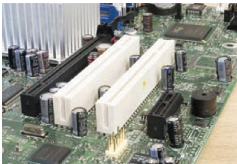
شکل ۳۰-۲ دو شکاف توسعه‌ی PCI به رنگ سفید و دو شکاف توسعه‌ی PCI-E به رنگ مشکی که سمت چپ ۱۶x و سمت راست ۱x هستند.
