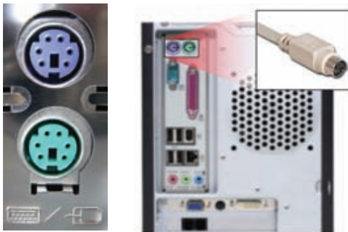
شکل ۲۴-۶ محل اتصال رابط‌های PS/2 صفحه کلید (رنگ بنفش) و ماوس (رنگ سبز)
