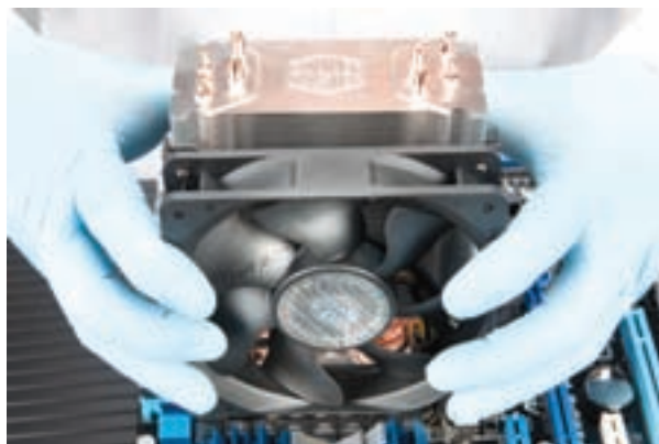
شکل ۸-۹ نصب خنک‌کننده‌ی پردازنده
