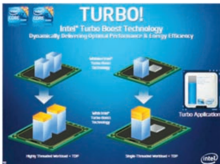
شکل ۴۶-۳ فناوری Turbo Boost در پردازنده‌های چند هسته‌ای سری‌های Core i5 و Core i7
