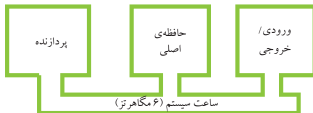
شکل ۲۳-۲ گذرگاه واحد در رایانه‌های اولیه، مدل XT، ساختار اصلی یک گذرگاه و با یک سرعت معین
