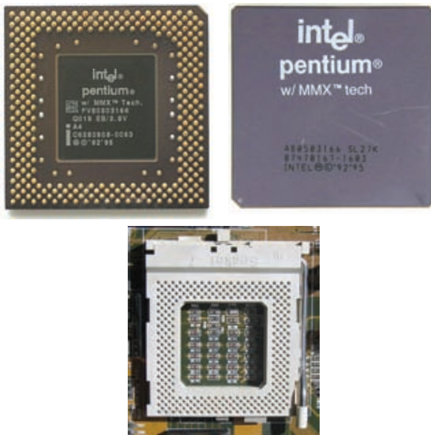
شکل ۳-۳۱ نمایهای جلو و پشت پردازنده‌ی پنتیوم MMX ۱۶۶ و سوکت شماره‌ی ۷
