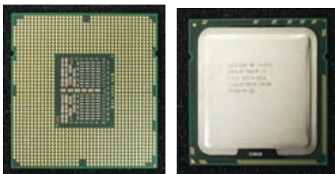
شکل ۴۲-۳ جلو و پشت پردازنده‌ی Intel core i7-975
