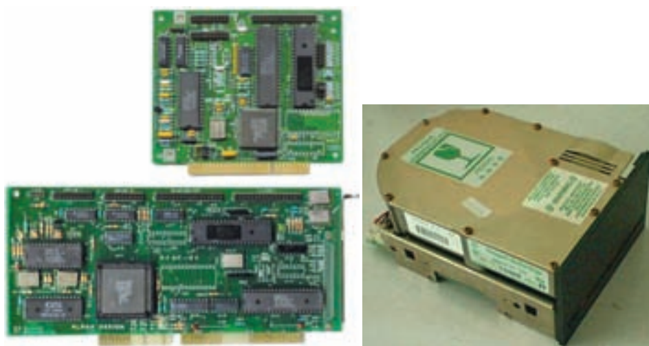
شکل ۴-۴۴ اولین دیسک سخت در رایانه های شخصی به نام ST-506 و کارت های رابط آن (بالایی در رایانه های XT و پایینی در رایانه های AT)
