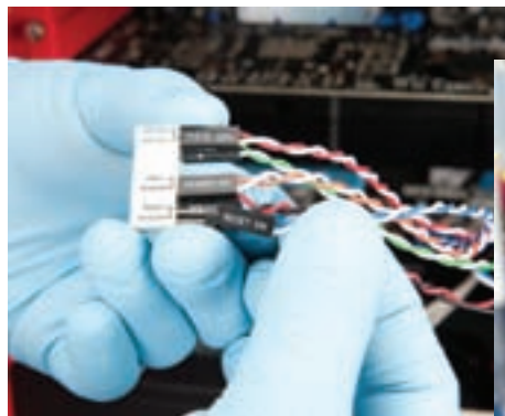
شکل ۱۹-۸ نصب و اتصال کانکتورهای پانل جلوی کیس
