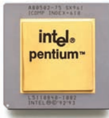
شکل ۳۰-۳ پردازنده ی پنتیوم ۷۵ و سوکت شماردی ۵
