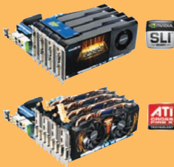
شکل ۸-۲۵ نصب کارت‌های گرافیک CrossFire و SLI
