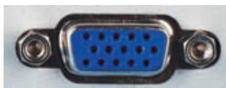
شکل ۱۵-۵ درگاه خروجی ۱۵ پین VGA برای اتصال به صفحه‌نمایش‌های آنالوگ
