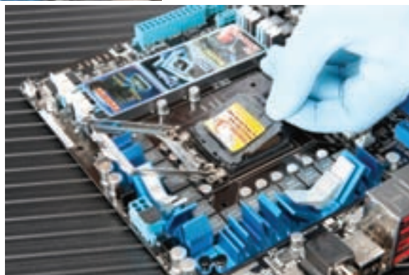
شکل ۸-۴ برداشتن پوشش محافظ سوکت پردازنده
