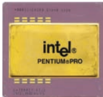
شکل ۳-۲۲ جلو و پشت پردازنده ی پنتیوم پرو با فرکانس ۲۰۰ مگاهرتز
