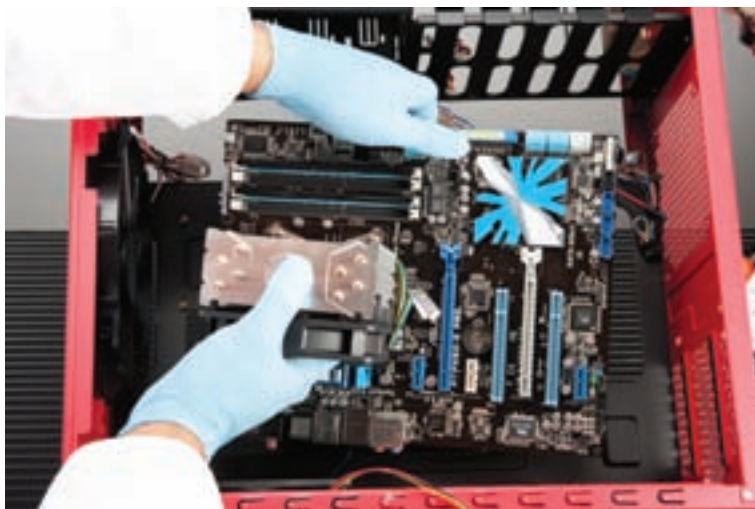
شکل ۸-۱۴ نصب برد اصلی
