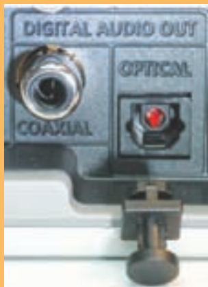
شکل ۲۷-۵ ورودی کابل نوری و کابل هم محور بر روی بلندگو
