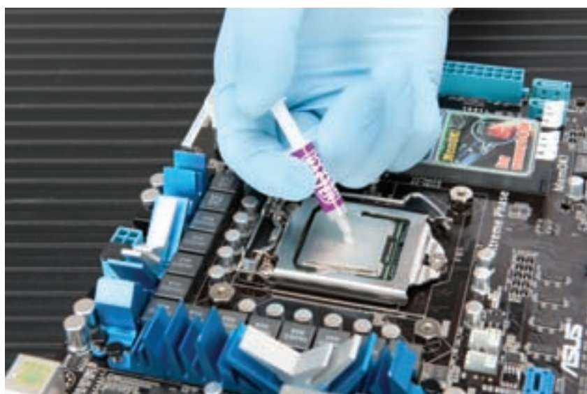
شکل ۸-۷ پوشاندن پردازنده با خمیر انتقال حرارت
