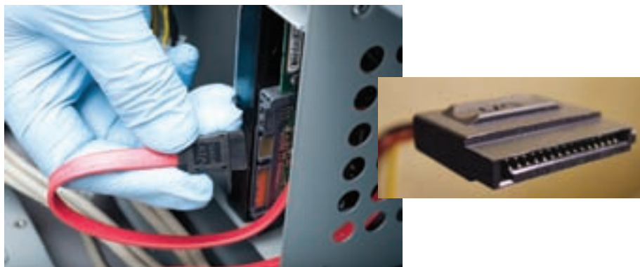
شکل ۲۴-۸ کابل برق و کابل انتقال داده‌های SATA و روش اتصال آن
