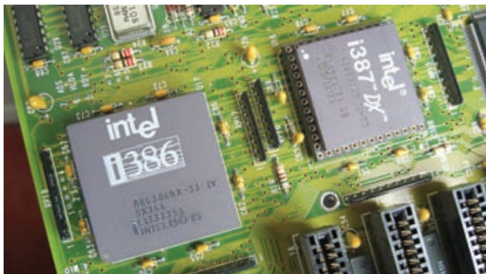
شکل ۱۳-۳ پردازنده‌ی ۸۰۳۸۶ DX و کمک پردازنده‌ی ۸۰۳۸۷ محصول شرکت اینتل
