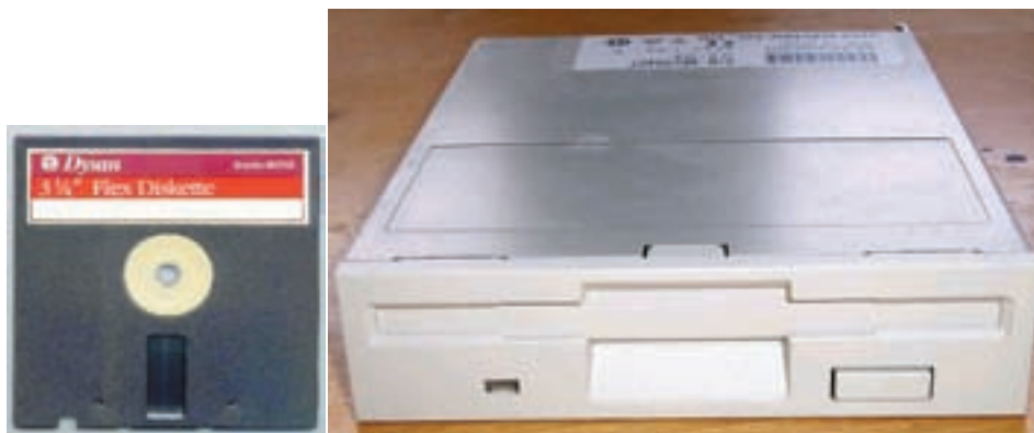
شکل ۲۸-۴ نمونه‌ای از فلاپی دیسک و دیسک‌گردان آن
