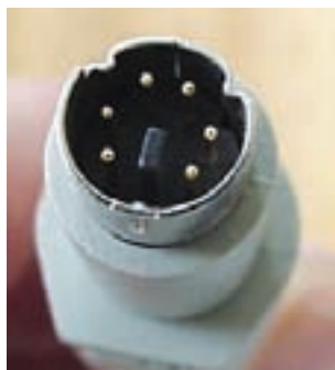
شکل ۱۲-۲ اتصال دهنده‌ی PS/2، سر کابل صفحه کلید
