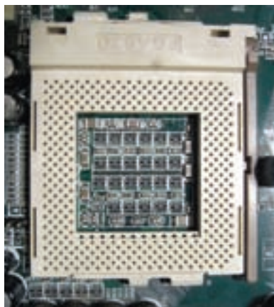
شکل ۳-۳۴ پردازنده‌ی سلرون و سوکت ۳۷۰ PGA
