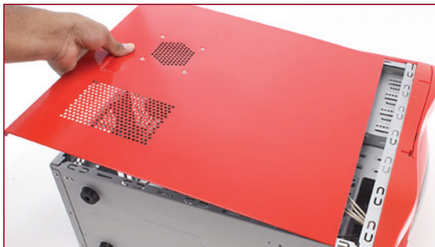
شکل ۸-۱ برداشتن قاب‌های جانبی
