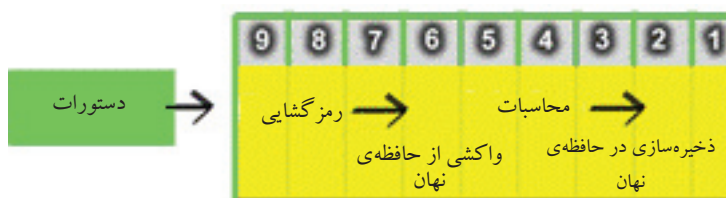
شکل ۳-۱۵ پردازش با استفاده از خط لوله
