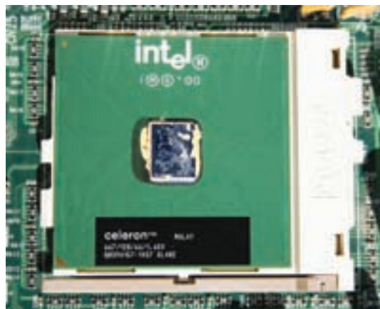
شکل ۳-۳۴ پردازنده‌ی سلرون و سوکت ۳۷۰ PGA
