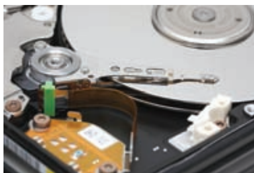
شکل ۴-۳۱ هد خواندن و نوشتن در دیسک سخت با دو صفحه
