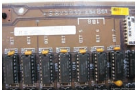
شکل ۹-۴ نوعی حافظه ی DIP که روی برد اصلی لحیم می شدند.
