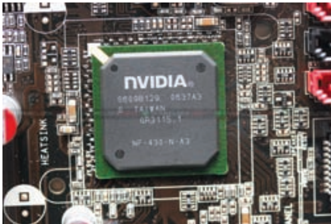
شکل ۵-۲ مدار واسطه گرافیکی که به صورت سرخود روی برد اصلی وجود دارد
