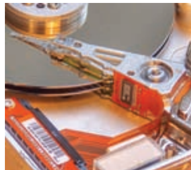
شکل ۴-۳۱ هد خواندن و نوشتن در دیسک سخت با دو صفحه
