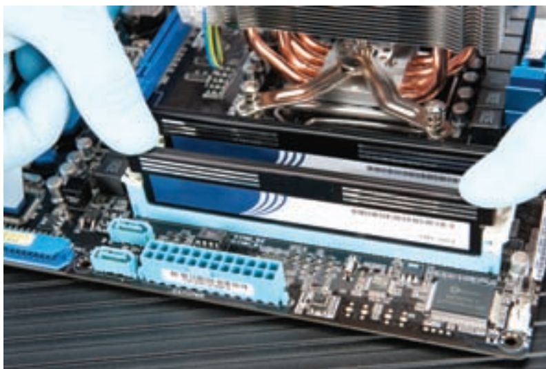
شکل ۸-۱۱ استقرار ماژول حافظه در شکاف حافظه
