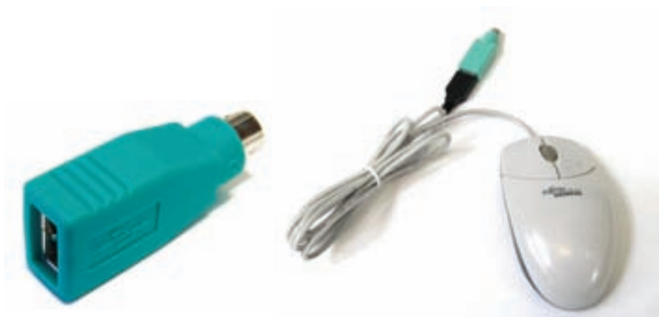
شکل ۲۹-۶ تبدیل USB به رابط PS/2 برای ماوس
