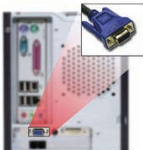
شکل ۱۵-۵ درگاه خروجی ۱۵ پین VGA برای اتصال به صفحه‌نمایش‌های آنالوگ
