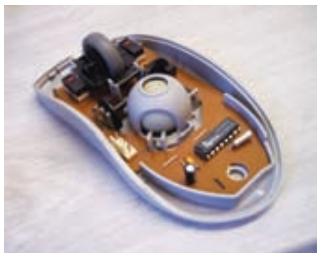
شکل ۲۷-۶ درون ماوس مکانیکی - نوری
