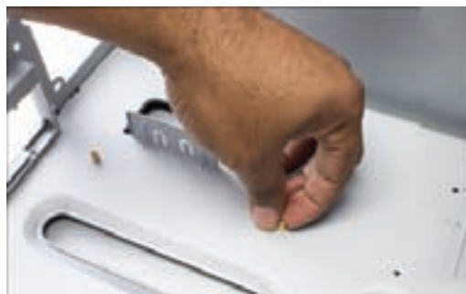
شکل ۸-۱۲ ثابت کردن پایه‌های برنجی
