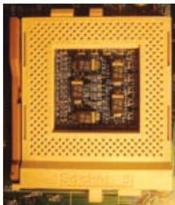
شکل ۳۰-۳ پردازنده ی پنتیوم ۷۵ و سوکت شماردی ۵
