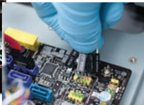
شکل ۱۹-۸ نصب و اتصال کانکتورهای پانل جلوی کیس
