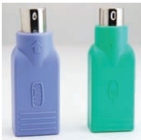
شکل ۲۳-۶ سمت راست، تبدیل کننده ی DIN پنج پین به PS/2 و سمت چپ، تبدیل کننده ی رابط USB به رابط
