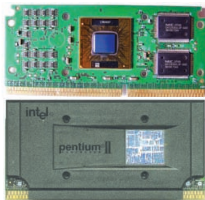
شکل ۳-۳۲ پشت و جلو پردازنده‌ی پنتیوم II با دو تراشه‌ی حافظه‌ی نهان و به صورت شکاف ۱
