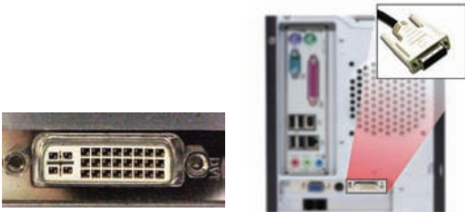
شکل ۵-۱۷ درگاه DVI برای اتصال به صفحه‌نمایش‌های دیجیتال
