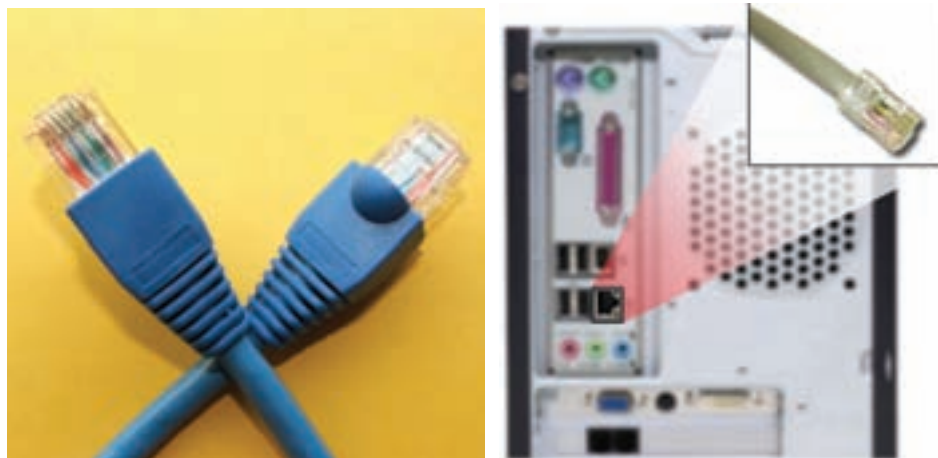
شکل ۳۶-۵ اتصال‌دهنده‌ی کابل شبکه در پشت کیس و سر کابل آن
