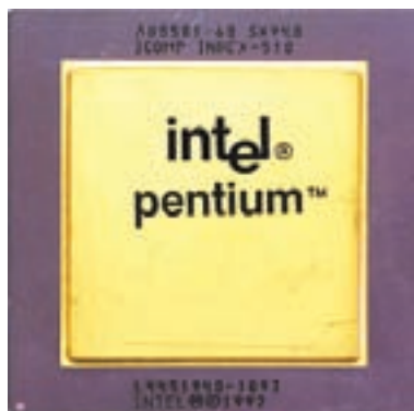
شکل ۲۸-۳ پردازنده‌ی ۸۰۵۸۶ معروف به پنتیوم محصول شرکت اینتل با فرکانس پالس ساعت ۶۶ مگاهرتز و سوکت شماره‌ی ۴
