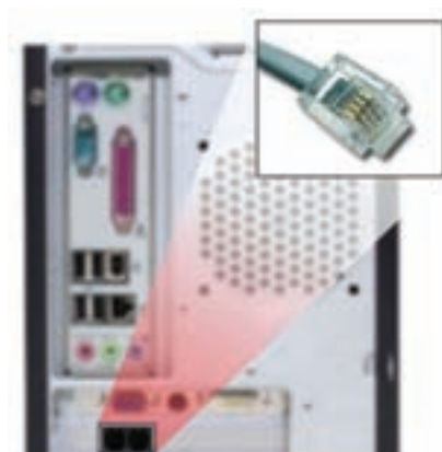
شکل ۵-۳۲ محل اتصال کابل‌های مودم به پشت کیس مربوط به مودم‌های داخلی و پریز تلفن
