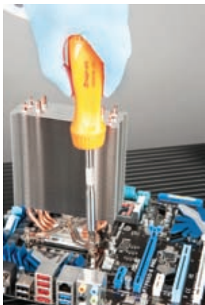
شکل ۸-۸ نمونه‌ای از نصب پایه‌ی خنک‌کننده
