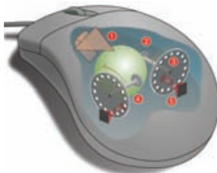
شکل ۲۷-۶ درون ماوس مکانیکی - نوری
