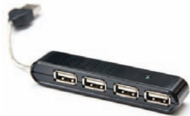
شکل ۲-۳۶ USB Hub با چهار درگاه
