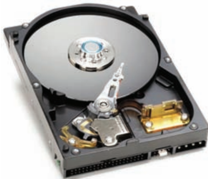
شکل ۲۹-۴ نمای داخلی دیسک سخت
