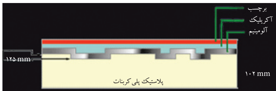
شکل ۴-۳۶ لایه های دیسک فشرده
