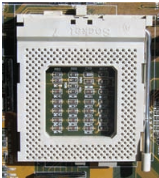
شکل ۲-۷ سوکت پردازنده از نوع ZIF
